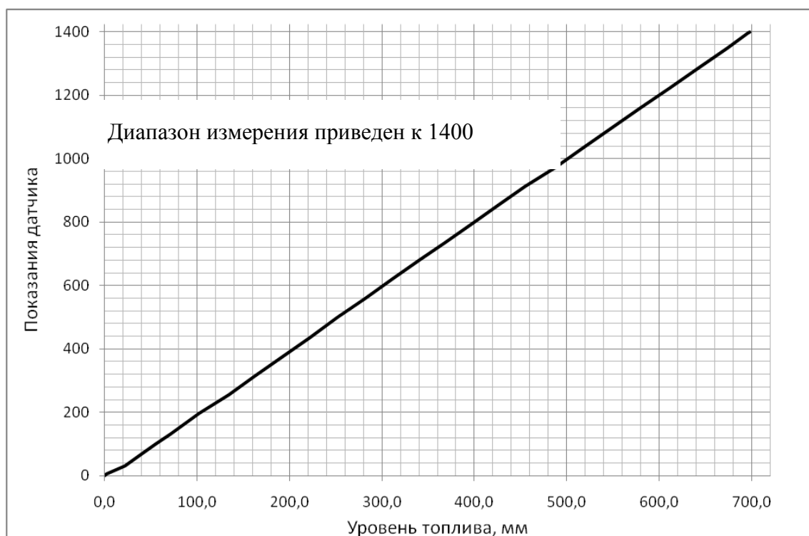
Рисунок 1. Зависимость преобразования результатов измерения уровня в код
